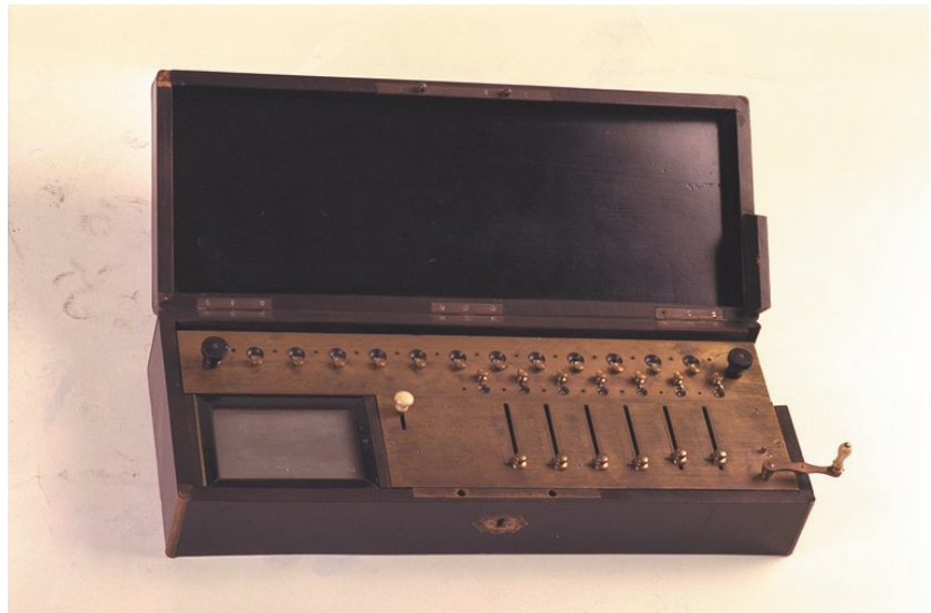
Abb. : Arithmomètre von 1870 ermöglicht alle vier Grundrechenarten.
