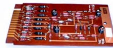
Schaltkreise aus der Z23: Transistorsteckkarte
