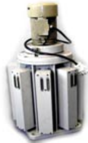
Magnettrommelspeicher der Z22/Z23 mit 8192 Worten à 40 Bit.
