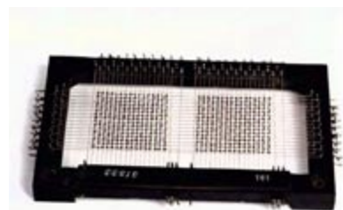
Schnellspeicher aus der Z22/Z23: Magnetkernspeichermatrix mit 512 Bit
