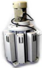
Magnettrommelspeicher der Z22/Z23 mit 8192 Worten à 40 Bit.
