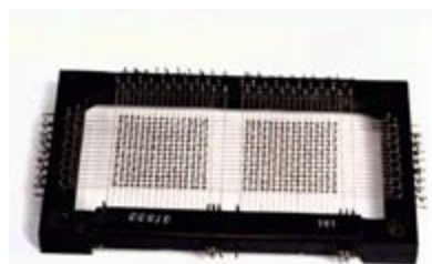
Schnellspeicher aus der Z22/Z23: Magnetkernspeichermatrix mit 512 Bit
